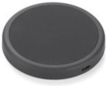
Das LUMEE 10W ist ein induktives Ladegerät, das mit seinem beleuchteten Logo die Aufmerksamkeit auf sich zieht. Es hat eine Soft-Touch-Beschichtung. Es unterstützt schnelles kabelloses Laden mit 10 W. Spezifikationen: - Eingang: 9V/1,67A - 5V/2A Ausgang: 9V/1,1A - 5V/2A - kompatibel mit dem Qi-Standard HINWEIS: Warten Sie nach dem Anschließen des Ladegeräts etwa 30 Sekunden, um das elektromagnetische Feld zu stabilisieren.
